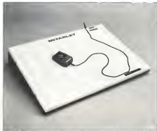
Figura 1 - Il digitizer WATANABE DT 1000. A sinistra di lavoro è di 1000 mm di lunghezza e di 300 mm di larghezza. A destra di lavoro è di 200 mm di lunghezza e di 300 mm di larghezza.
